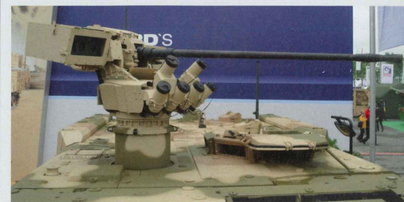
Die FLW 200+ mit einer 20mm Maschinenkanone, die den Einsatzkräften noch mehr Feuerkraft geben würde. Gut zu erkennen ist auch die Waffenerhöhung von 30cm, wie es der im Einsatz befindliche GTK BOXER A1 hat. (Foto: Mönch/AF)
